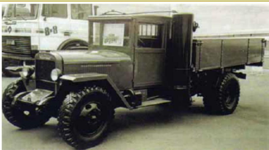
Рис. 4. «УралЗИС-5» с газогенераторной установкой
