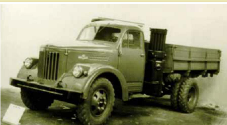
Рис. 5. Газогенераторный «ЗиС-21»
