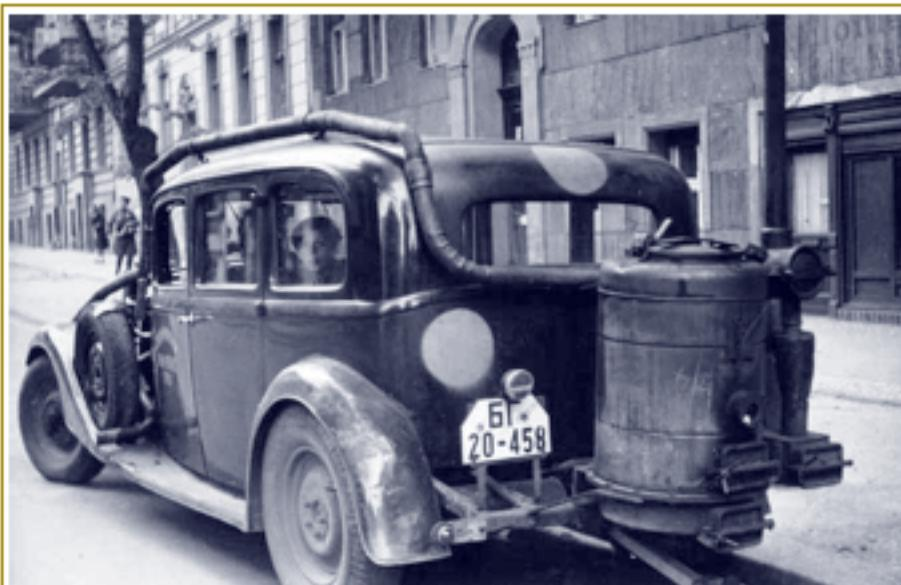
Рис. 3. Газогенераторный легковой автомобиль
