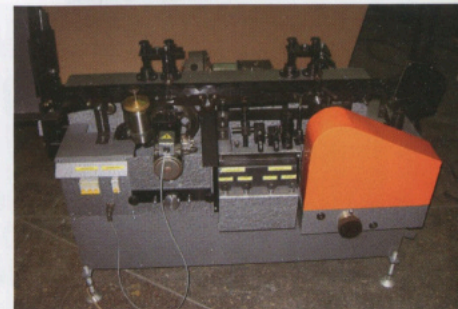
Приставка к ампульной машине для резки, оплавки и нанесения кольца отлома на ампулах
