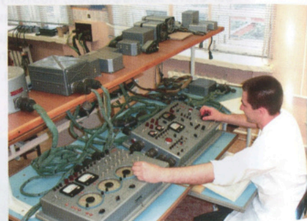
Рабочее место для проверки и регулировки систем автоматического управления летательными аппаратами
